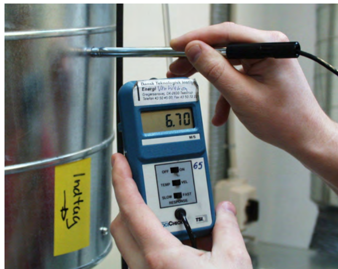
Figur 1: Varmetrådsanemometer (måling af lufthastighed i kanal)
